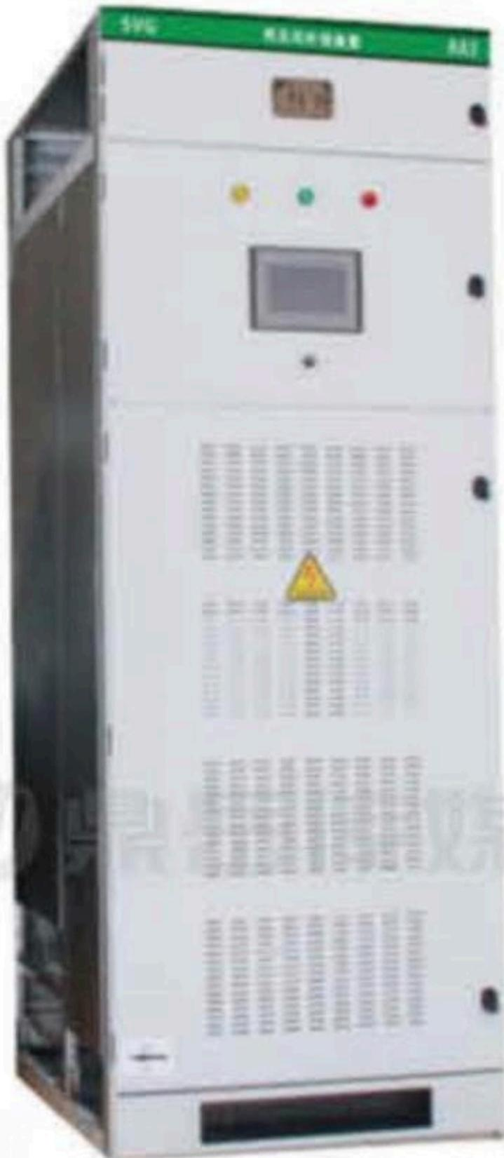
静止无功发生装置是采用现代电力电子技术和基于高速 DSP 器件的数字信号处理技术制成的新型无功补偿专用设备。它由指令电流运算电路和补偿电流发生电路两个主要部分组成。指令电流运算电路实时监视线路中的电流，并将模拟电流信号转换为数字信号，送入高速数字信号处理器 (DSP) 对信号进行处理，来分析负载电流的无功含量，并以脉宽调制 (PWM) 信号形式向补偿电流发生电路送出驱动脉冲，驱动 IGBT 或 IDM 功率模块，产生满足要求的无功补偿电流，并将无功补偿电流注入电网，从而实现动态无功补偿目的。
