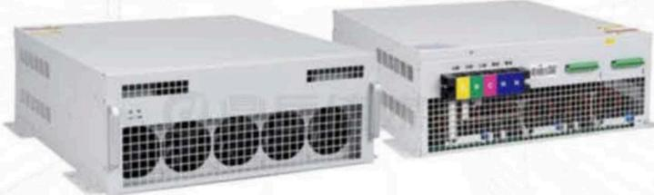
APF 30A ~ 200A 系列有源滤波器应用于抑制电力谐波、动态无功补偿的三电平，高功率密度电力电子产品。该产品技术达到国内领先水平，产品系列包括 30A、50A、75A、100A、150A 规格；具备谐波补偿，无功补偿，三相不平衡补偿功能，可灵活配置成单一、混合模式的补偿方式，可广泛应用于 0.4KV 供电系统的电能质量改善。
